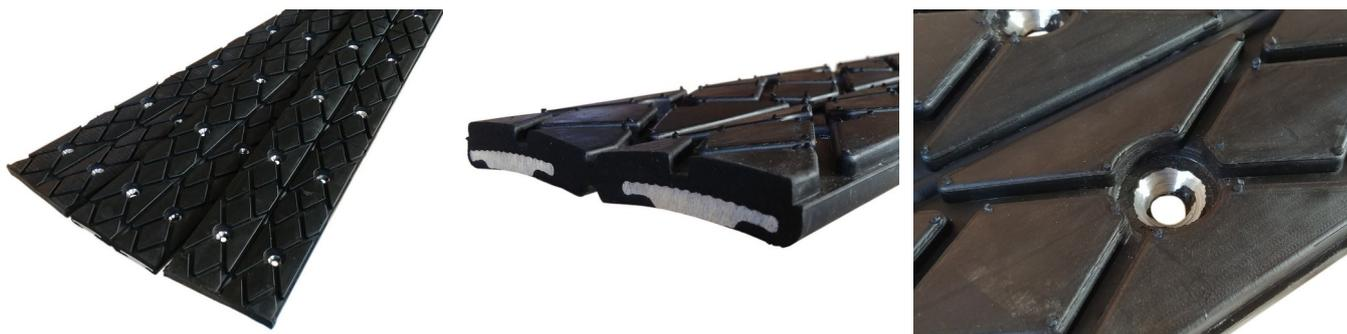
Футеровочные пластины **Just-Grip Fast-Lag** используется для футеровки приводных и не приводных барабанов ленточных конвейеров. Они представляют собой резиновые планки шириной 140 мм, состоящие из двух 70 мм профилированных резиновых сегментов с вулканизированными алюминиевыми профилями. Гибкое резиновое соединение сегментов позволяет сгибать планки посередине, что обеспечивает лёгкое крепление болтами на округлой поверхности барабана.
