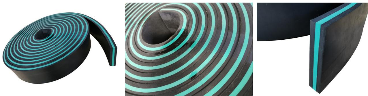
Комбинированная трехслойная чистящая/скребковая резина Just-SKIRT COMBI GREEN состоит из износостойких наружных слоев (65 по Шору А) и эластичного внутреннего слоя (45 по Шору А).
