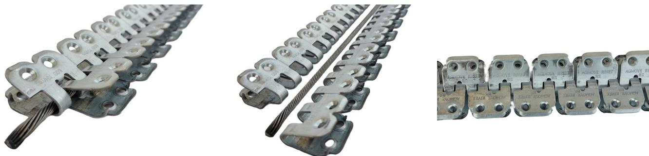
Соединитель Rivet Lacing состоит из двух частей, которые крепятся к краям ленты с помощью специальных заклепок и соединяются между собой тросом, образуя надежный и прочный стык.
